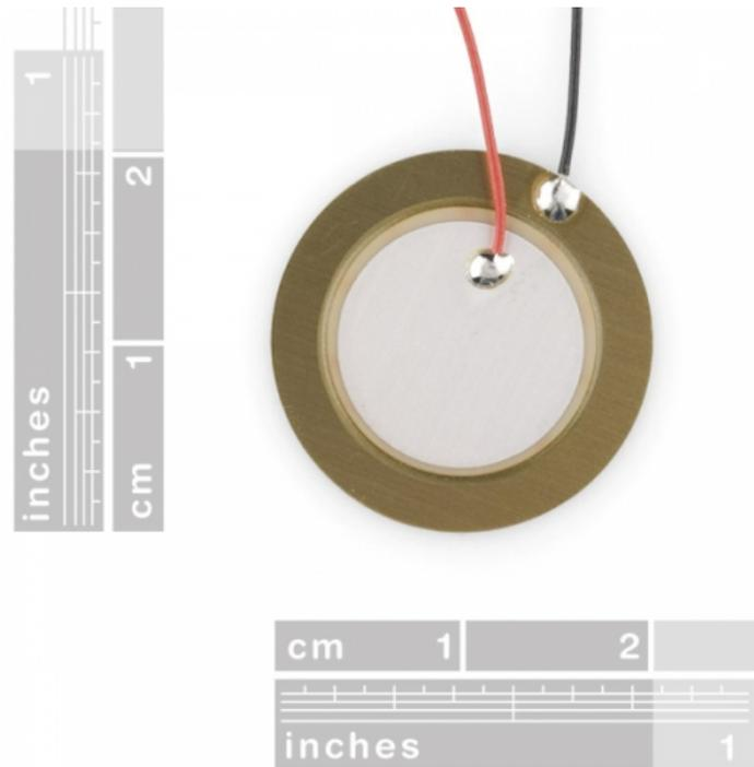
È realizzato con materiali che sfruttano l'effetto piezoelettrico: quando viene applicata una pressione esterna cariche di segno opposto si posizionano sulle facce opposte e se collegate ad un circuito viene generata una corrente. Al contrario se viene applicata una differenza di potenziale sulle due facce il materiale si espande e si contrae.
