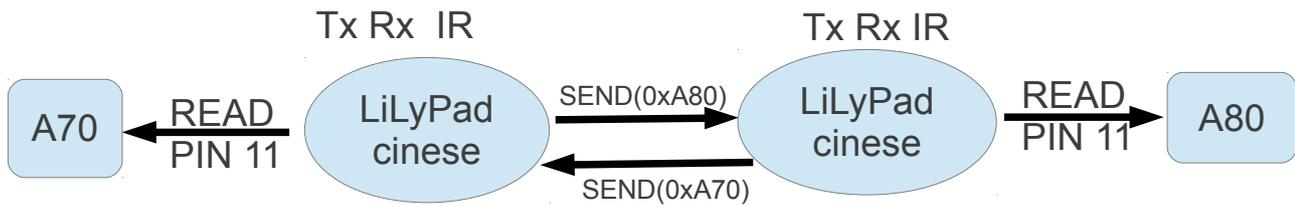
Esito **OK**, uno trasmette A70 e l'altro A80 . La lettura del dato Sul Pin 11 è apprezzabile, non si notano particolari disturbi.
